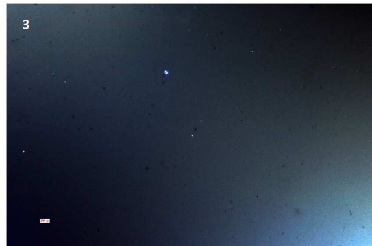
Fig. 5 Vetrino su piastra magnetica Polarità Nord. Distribuzione uniforme TiO2 dopo evaporazione
