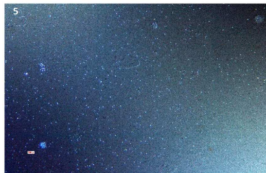
Fig. 5 Vetrino su piastra magnetica Polarità Nord. Distribuzione uniforme TiO2 dopo evaporazione
