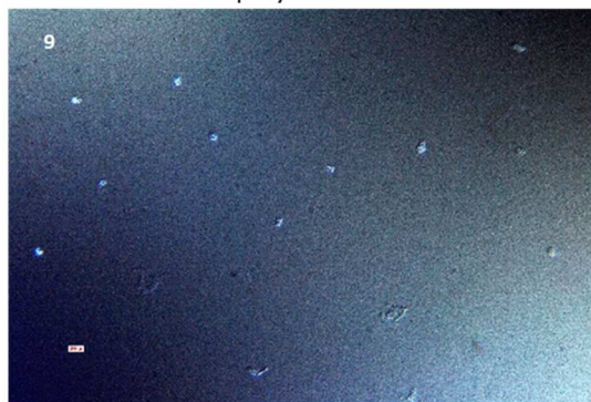
Fig. 9 Deposito raccolto in cluster separati Spray a turbina
