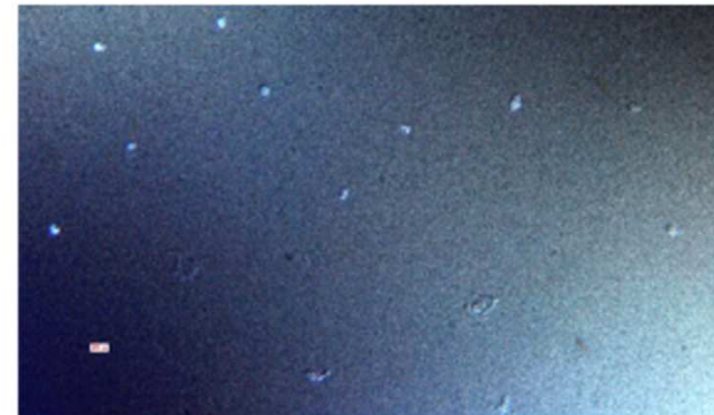
Deposito separato in cluster di TiO 2 con Spray a turbina
